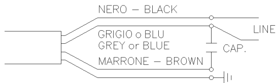
Figura 1: Schema di collegamento per motore 4" serie GG versione monofase Figure 1: Wiring diagram for motor 4" GG series single-phase version Figure 1: Schéma de connexion pour moteur 4" série GG version monophasée Rysunek 1: Schemat podłączenia dla silnika 4" serii GG wersja jednofazowa Figura 1: Esquema de conexión para motor 4" serie GG versión monofásica
