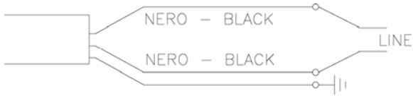
Figura 1: Schema di collegamento per motore 4" serie TW 2Wire Figure 1: Wiring diagram for motor 4" TW 2Wire series Figure 1: Schéma de connexion pour moteur 4" série TW 2Wire Rysunek 1: Schemat podłączenia dla silnika 4" serii TW 2Wire Figura 1: Esquema de conexión para motor 4" serie TW 2 Wire
