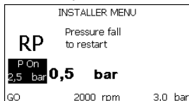
Kuva 17: Uudelleenkäynnistyspaine aset
